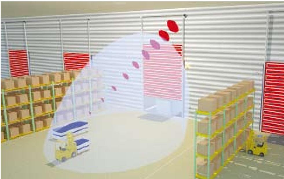
Ejemplo de instalación en contexto industrial de PASSY ANTENA MONODIRECCIONAL. La puerta que da acceso a la rampa de carga se abre cuando una carretilla elevadora, dotada de PASSY TRANSPONDER asociado, entra en la zona de cobertura de la antena.
